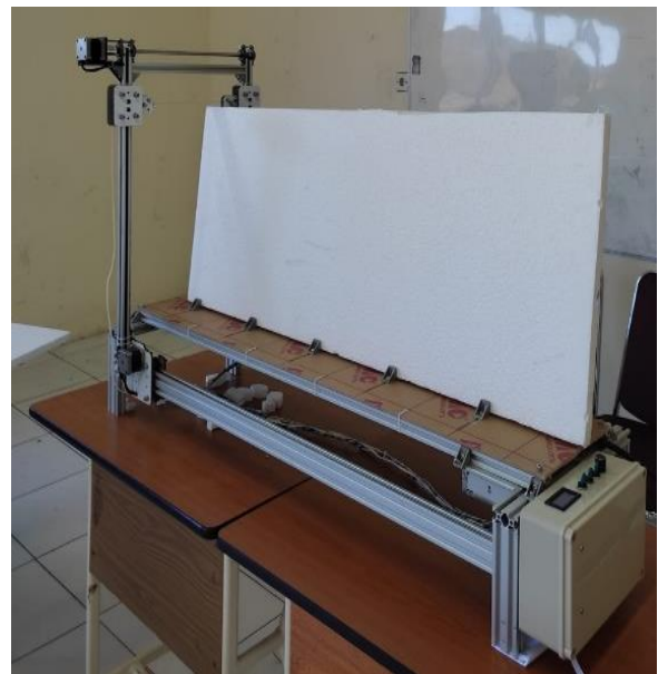
Gambar 1. Mesin Pemotong Styrofoam Berbasis CNC 2 Axis Menggunakan Hot Wire.
